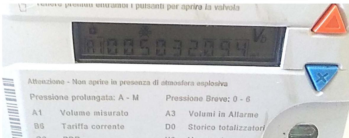
Come si può notare dall'immagine, nella riga superiore appare la scritta Vb e nella riga inferiore A1 a sinistra ed il valore del totalizzatore espresso in metri cubi con 6 cifre e 3 decimali dopo il punto.
